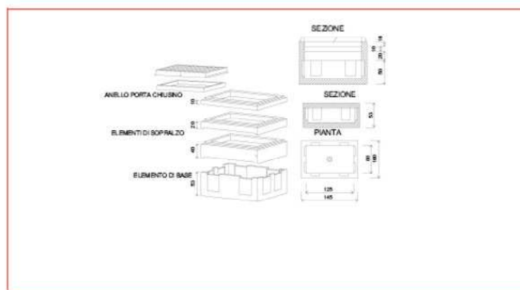
FIGURA 20 Elementi dei pozzetti 125 x 80
